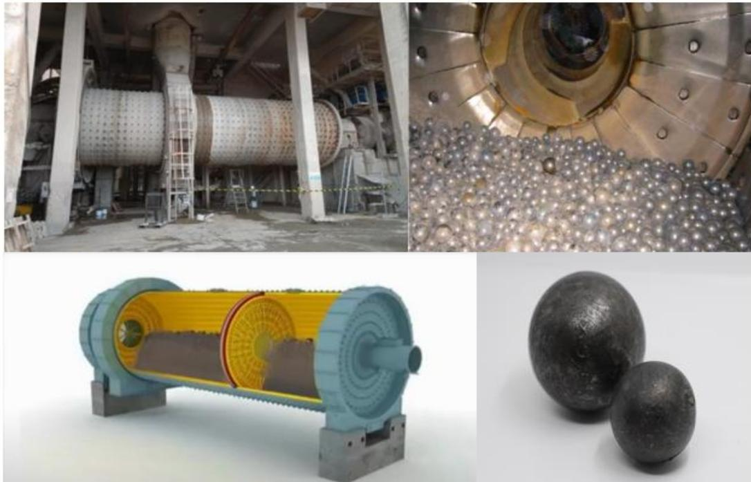
Figure 18 : Broyeur à boulets
