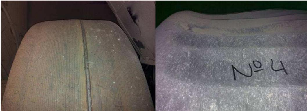
Figure 28 : Galet avec un nouveau bandage et un bandage usé
