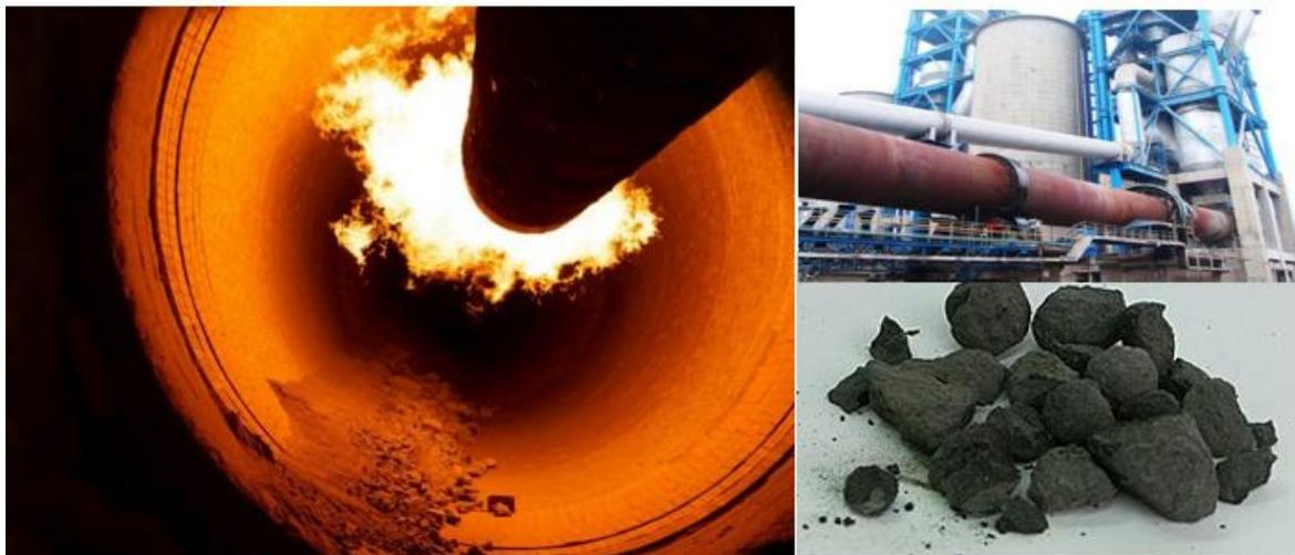
Figure 13 : Photographies d'un four rotatif, de la flamme et du clinker
