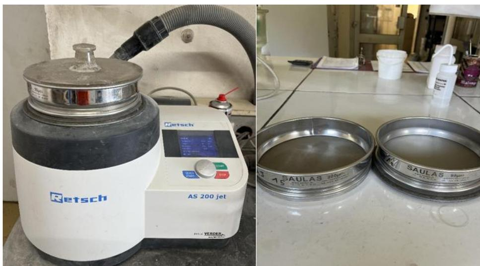
Figure 22 : Tamiseuse alpine Retsch avec les deux tamis de 90 et 200 µm
