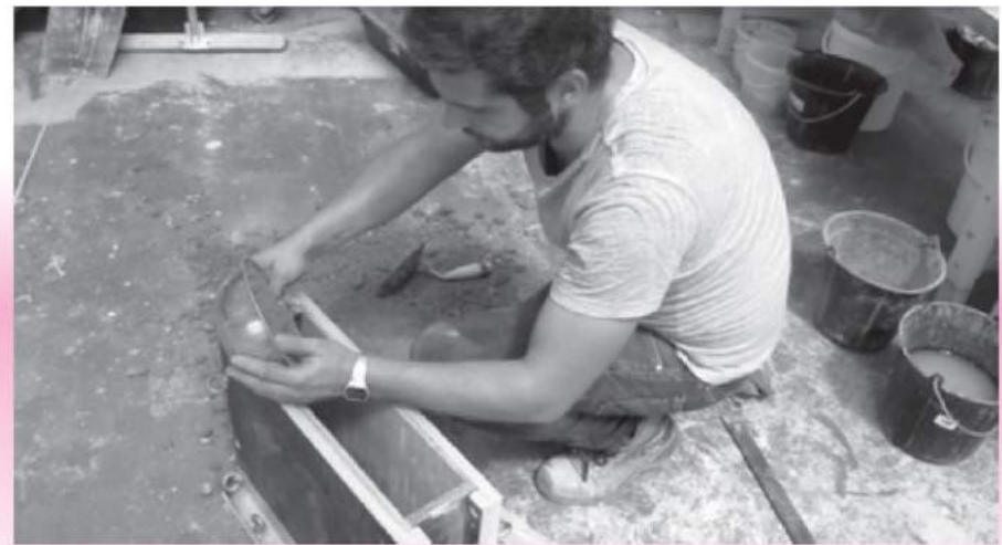
(20) En laboratoire, comme en situation de chantier, le versement du mélange doit se faire de manière régulière, en lits de quelques centimètres, dans le coffrage.
