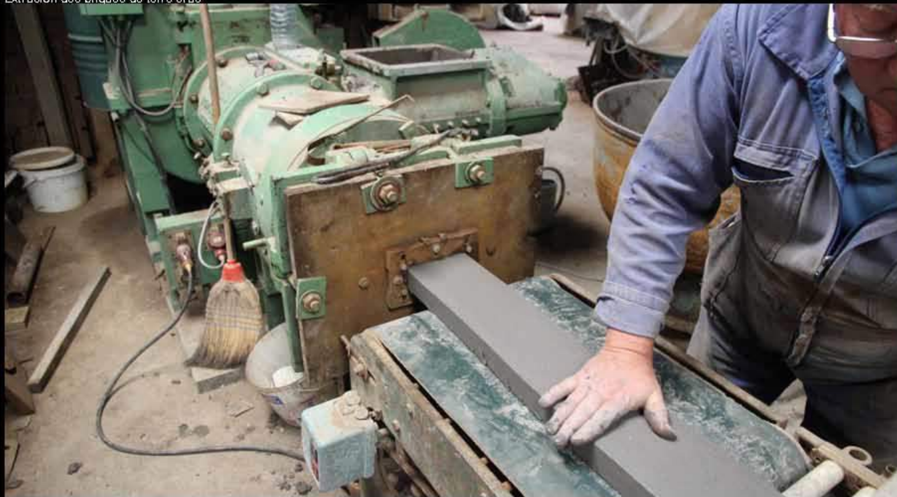
Extrusion des briques de terre crue
