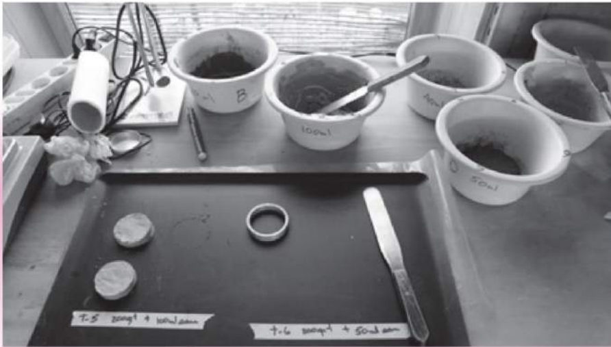
(11) Le test de la pastille consiste à mouler des pastilles de terre dans des cercles métalliques. Après séchage, il est possible de comparer le retrait des différentes terres. Afin d'évaluer leur cohésion, les pastilles sèches sont ensuite rayées avec l'ongle et brisées à la main.
