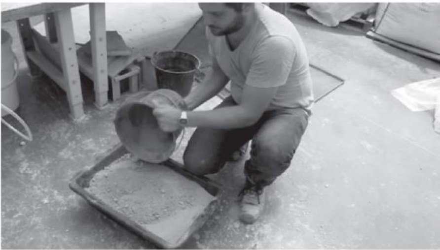
(17) Les formulations sont suivies de la fabrication de plusieurs prototypes selon des techniques variées. La mise en œuvre d'un matériau compacté tel que le pisé est réalisé à partir d'un mélange de terre de retraitement non chaulée, d'une certaine quantité d'argile et d'eau.
