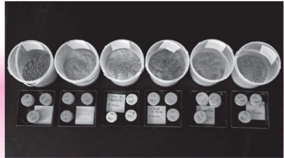
(12) La lecture globale des échantillons et des pastilles permet d'une part d'évaluer la palette chromatique à disposition et d'autre part de comparer les retraits des différentes terres correspondant aux potentialités des matériaux.
