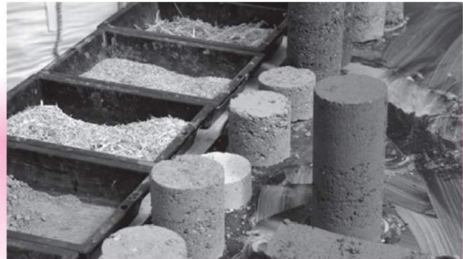
(16) Certaines formulations sont mélangées avec des fibres naturelles (chanvre ou paille). Cette technique permet de produire des matériaux allégés (brique allégée, panneaux d'argile...).
