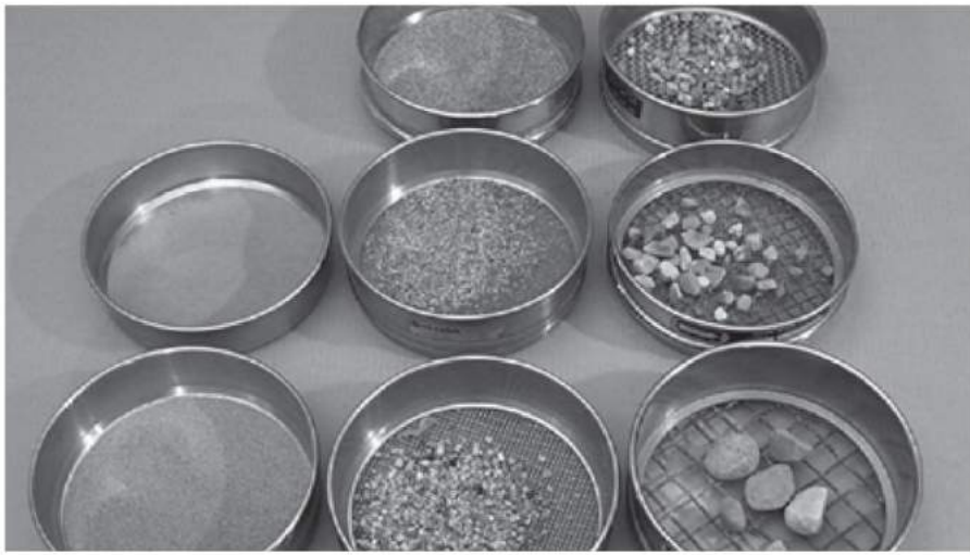
(9) Chaque terre ou granulat est un mélange de grains de différentes tailles, en proportions variées : cailloux, graviers, sables, silts (limons) et argiles. La granulométrie est un test de laboratoire qui permet ainsi de séparer ces grains par catégories de taille afin de connaître la composition granulaire de ces matières premières.
