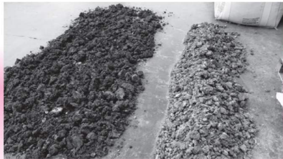
(8) Les terres aux particules les plus fines (argiles et limons) sont broyées après séchage. Le broyage permet de désagglomérer les particules d'argiles en vue de leurs analyses.
