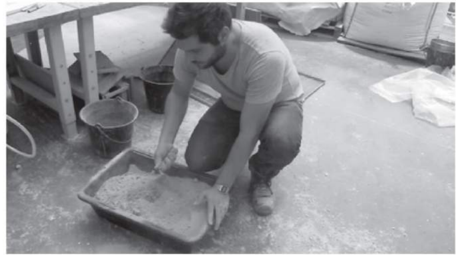
(18) Un premier mélange de terre non chaulée et de poudre d'argile est effectué à sec afin d'optimiser la répartition de l'argile autour des grains. Pour d'autres techniques comme les enduits, le mélange par voie humide ou en barbotine est préférable.
