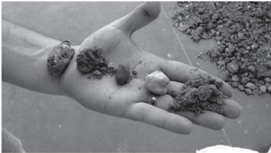
(5) Dans un premier temps, de rapides manipulations permettent d'apprécier si les terres prélevées sont plus argileuses ou sableuses.
