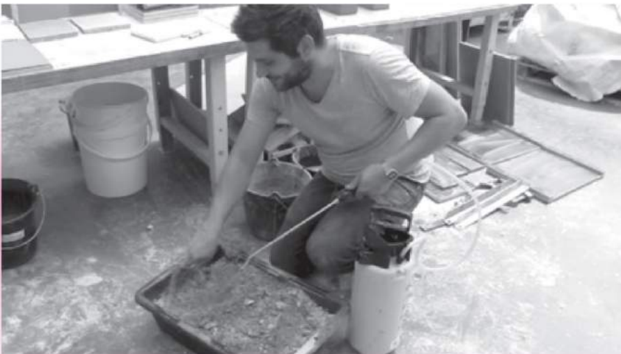
(19) La portion convenable d'eau est ensuite incorporée au vaporisateur pour rendre la matière plus homogène. À échelle réelle, le mélange se fait au jet d'eau.
