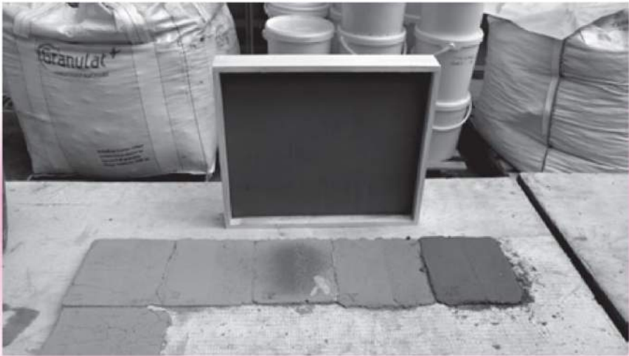
(15) Chaque technique de mise en œuvre nécessite ainsi une série de tests aux formulations différentes afin de définir la qualité et l'aspect du matériau visé, comme par exemple les enduits.
