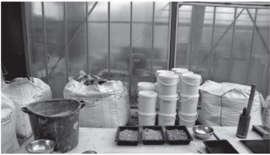
(13) À partir des résultats des analyses, l'étape de formulation consiste à mélanger, si nécessaire, les terres et granulats initiaux avec de l'eau et à trouver les bons dosages pour transformer ces ingrédients en matériaux de construction.
